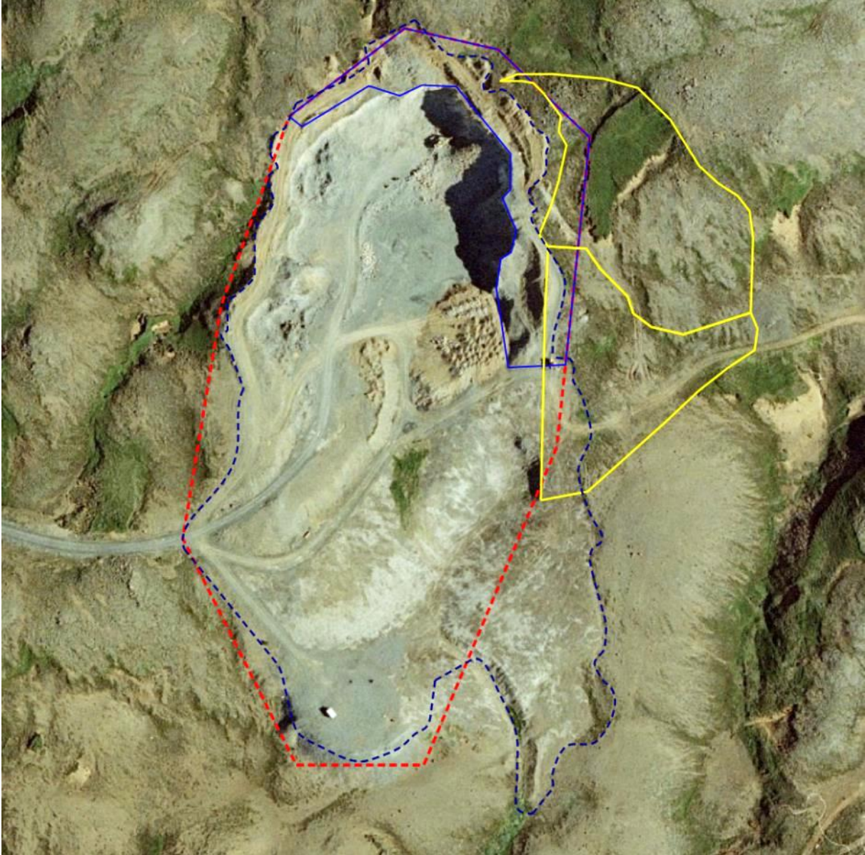
MYND 2.2 Yfirlitsmynd af Seljadalsnámu sem sýnir útlínur efnistökusvæðisins á gildandi aðalskipulagi (rauð brotalína), útlínur áður raskaðs svæðis (blá brotalína), útlínur svæðis sem var fjallað um í umhverfismati 2014 (blá heil lína) og útlínur þess efnistökusvæðis sem er til skoðunar í þessu umhverfismati (gul lína).
